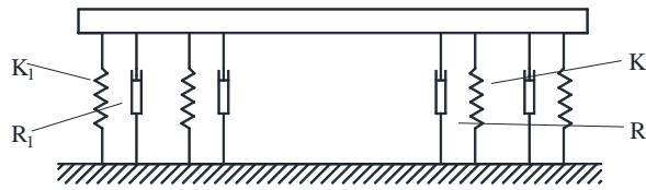
图 4.3 粘弹性材料并联布置示意图
