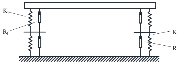
图 4.4 粘弹性材料串联布置示意图
