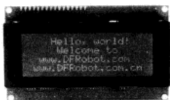
IIC LCD2004 基于IIC总线控制的液晶模块
