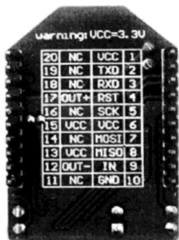
图7.5 DFduino wireless无线模块引脚定义
