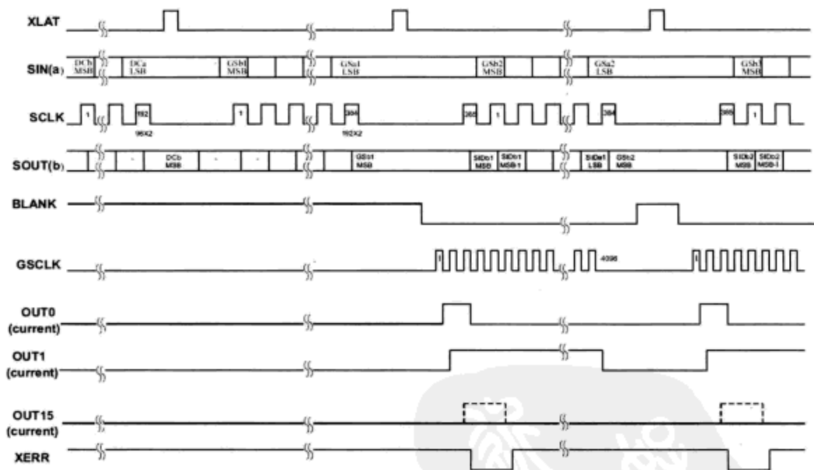
图5.32 TLC5940NT PWM LED驱动芯片的控制时序
