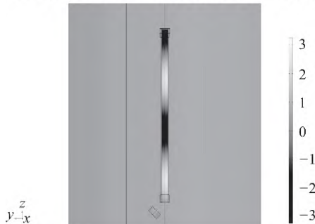
图 10 闭管发生谐振时的声压分布图
