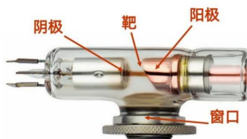
图 7-1-1 X 射线管的主要结构
