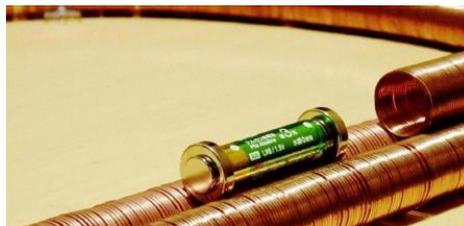
图 1 磁力小火车装置图
