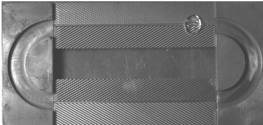
Figure C.3 – Dispositifs utilisant les textures en forme de chevron comme unité de base. (a) Deux chevrons juxtaposés avec des polarités opposées permettent de piéger une goutte à leur intersection. (b) Deux chevrons reliés par des sections circulaires vont faciliter l'observation du mouvement de la goutte sur de très longues distances.
