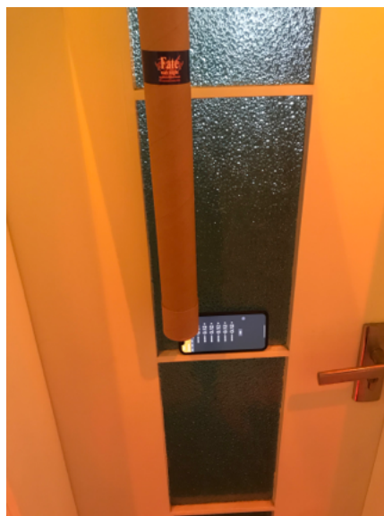
图四 长物体下落法测定重力加速度
