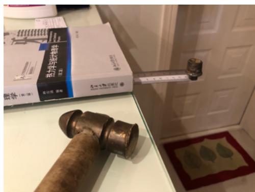
图二 重物坠地法测定重力加速度实验装置
