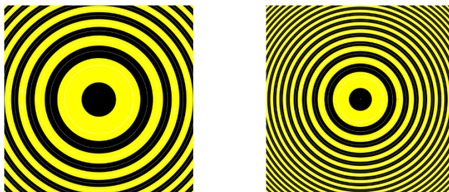
图 6 普通牛顿环理论模拟展示 (左图为曲率半径 1.8m 时, 右图为曲率半径 0.8m 时)
