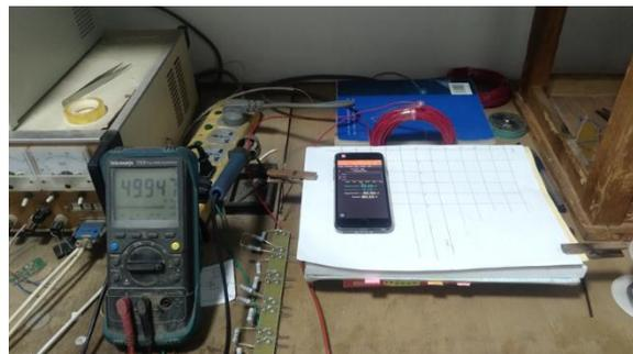
图（10）通电圆线圈一侧垂直平面上的磁感应强度分布测量
