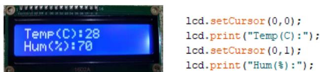
图2 lcd 显示温湿度
