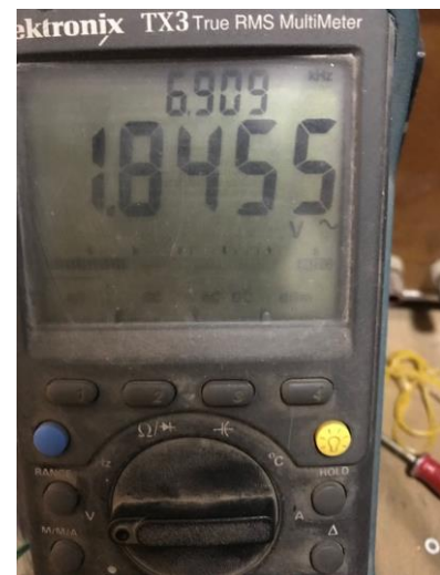
图（10） 万用表测输出频率
