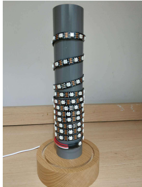
图 7 将灯带缠绕到 PVC 管
