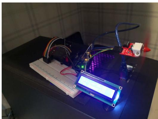
图六 程序运行结果。液晶屏上的显示为：“Celsius: 26.86 Fan Speed: 42%”
