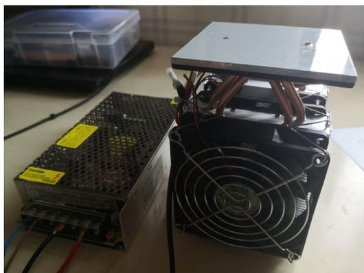
图三 冷源部分硬件组装实物图
