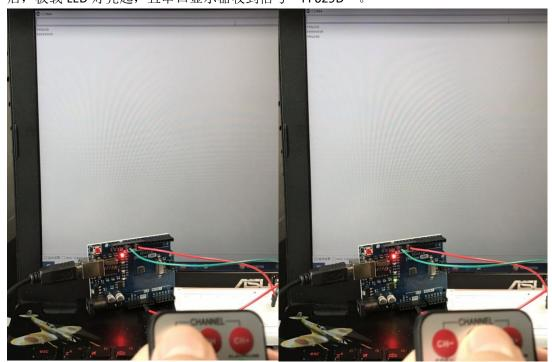
2. 对着红外接收头按下按键 "CH+"后,板载 LED 灯没有任何明灭变化,且串口显示器显示收到信号 "FFE21D"。对着红外接收头按下按键 "CH-"后,板载 LED 灯熄灭,且串口显示器显示收到信号 "FFA25D",说明实验基本成功。
