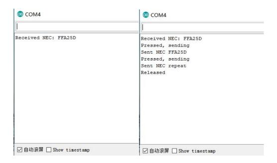
2. 对准红外解码器按下红外遥控器的"0"按钮,在串口监视器中显示"FF6897",说明红外解码器收到了"0"的信号。之后按下按键开关,串口监视器收到了依托 NEC 协议的"0"红外信号,说明了红外解码器保存了"0"信号,识别了"0"信号和发送了"0"信号。通过上面两次实验,初步判定红外解码器设计成功。
