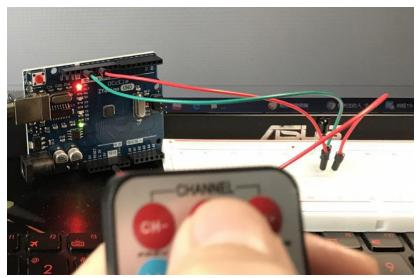
所需实验器材:一体化红外接收头,Arduino UNO,红外遥控器,导线若干。
