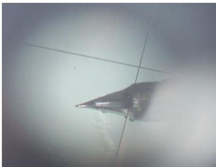
图 1 直流电源制得的针尖
