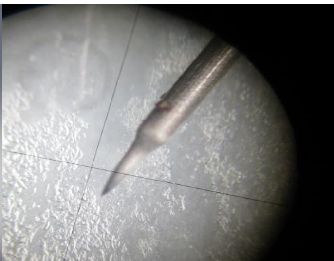
图 2 交流电源制得的针尖
