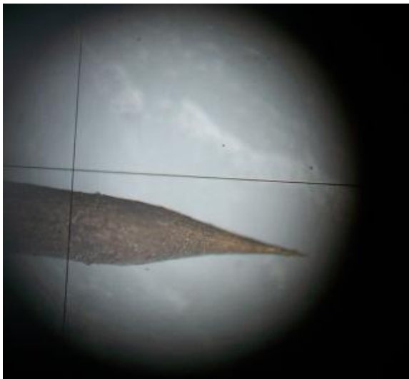
图3 5V电压制得的针尖
