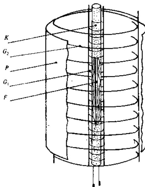
实验电路图如右图所示，对灯丝加电压 $V_F$ （1~5V），对其加热从而使之发射电子； $V_{KG1}$ 为抽取电压（0~5V），用以消除电子在阴极附近的堆积效应； $V_{KG2}$ （0~100V）为电子加速电压； $V_{G2P}$ （0~15V）为反向电压，用以控制能够到达阳极P的电子的最小动能。
