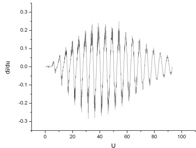
本底为何的问题,我采用了将原图微分的方法.微分后得到电流在不同加速电压下的变化快慢图(图2),而此时的峰对应原图中增长最快的点,统计这里的峰值如表1所示:
