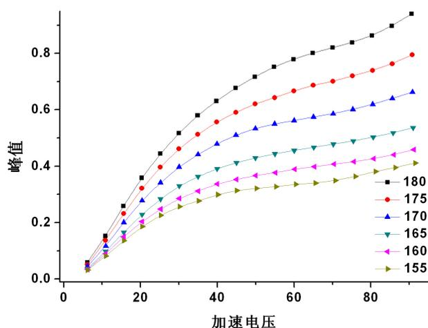
与此同时，通过对数据的分析还发现，除峰值以外，峰间距的大小也随温度而改变。为探究温度对谱线造成的影响，现引入一个造成谱线出现周期振荡的模型。
