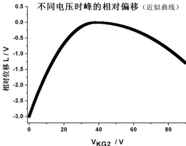
由于电子在不同的加速电压下，碰撞情况的不同似的电子能量也发生改变。分析得出能量对与加速电压的修正如左图所示。
