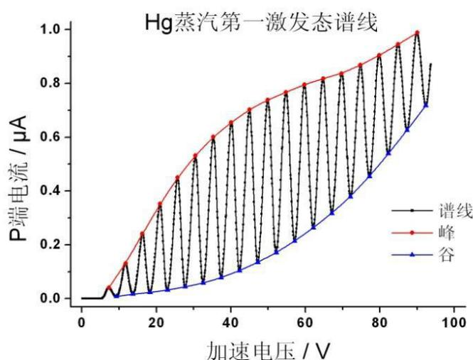
左图为温度在 180 度下的弗兰克-赫兹谱线，在实验的过程中观察到，谱线形状因温度的改变而出现显著的差异。
