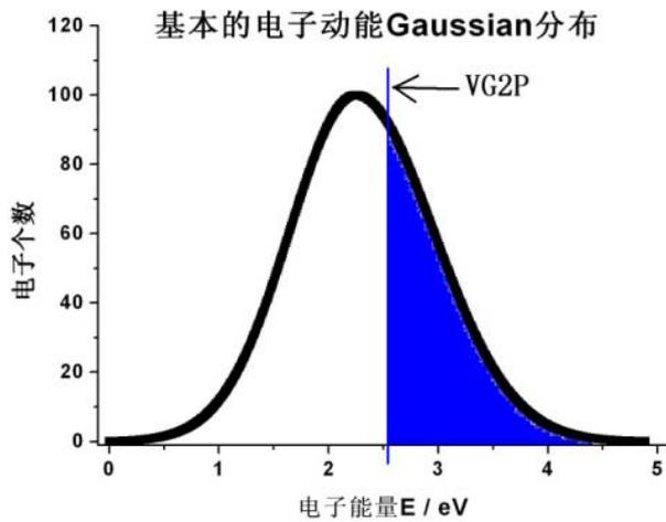
Hg 原子第一激发态为 4.9eV，而且谱线的周期也接近 4.9V，便构造一个 4.9V 的电子能量范围。在某种情况下电子的能量恰好在这个范围内成 Gaussian 分布。（加速电压为  $V_{KG2}$ ）
