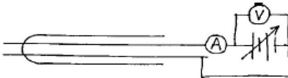
图 1：双探针法测等离子体参数装置示意图
