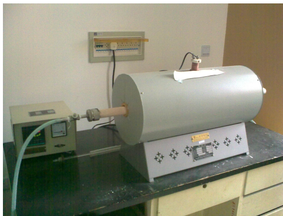
AI-708P(V6.5)程序型智能温度调节器(左)和 SK2-2-12 管式电阻炉(右) 超导材料零电阻效应验证:
