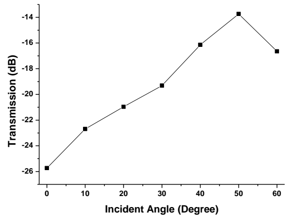
图7 (左) 16mm 四级分形板不同入射角入射时的透射谱线, (右) 在 1.56GHz 处透射率与入射角的关系
