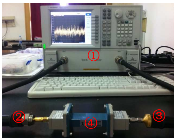
图 1 本实验操作平台照片, ①为 Agilent 网络分析仪, ②为信号输入线, ③为信号探测线, ④为波导, 内部可嵌入透射片
