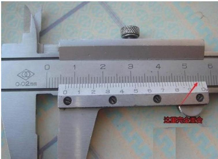
图 1 用游标卡尺测量某物体的长度
