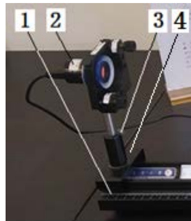
1-光(图像)传感器调节架位置刻度线 2-光传感器 3-光传感器固定旋钮 4-调节架底座
