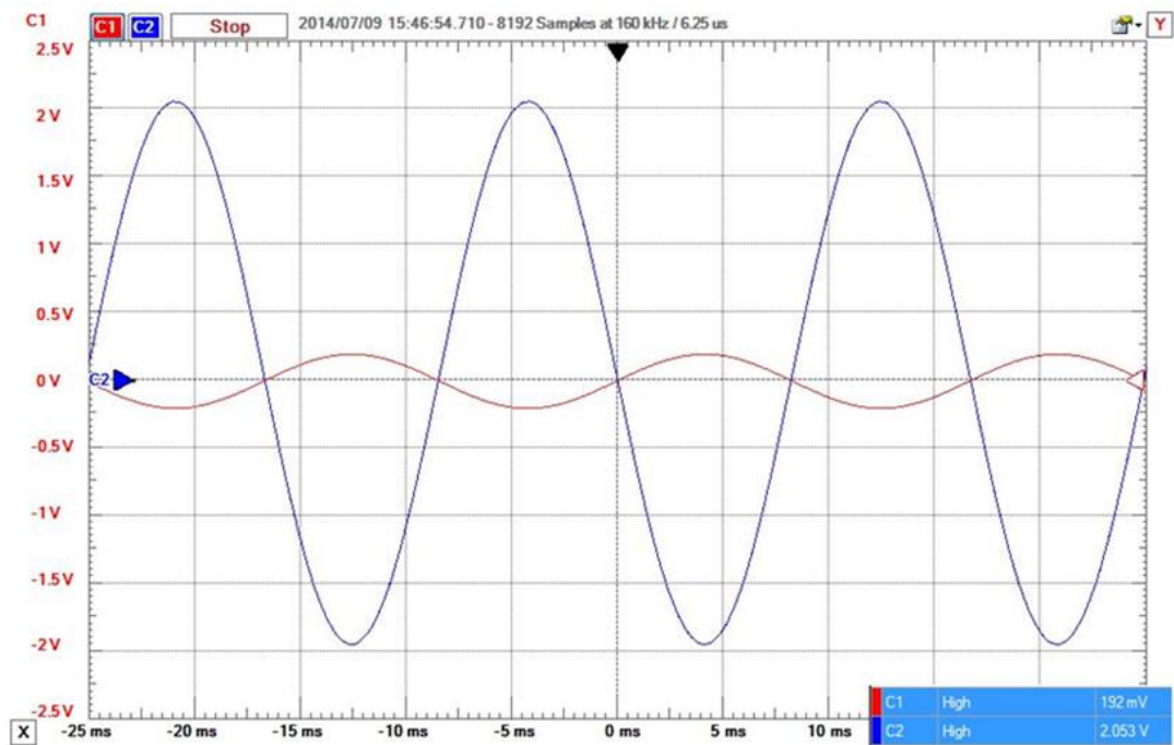
图 5 200 mV 小电压信号经放大电路放大 10 倍后为 2 V
