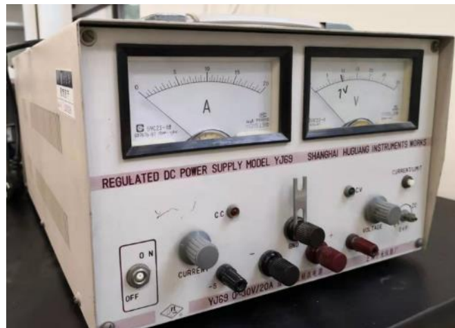
实验室里看到的笨重的电源： 20A、30V
