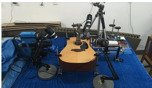
图3.3 吉他弦振动非接触光学测量实验平台
