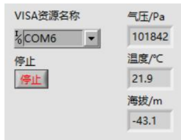
图 50 读取 BMP180 气压传感器
