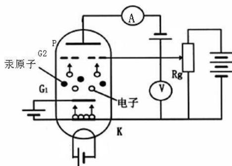
图一 测量 Hg 第一激发能原理示意图
