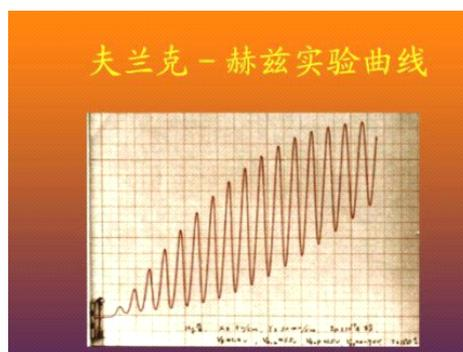
图二 Hg 第一激发能态曲线  $I_P-V_{G2K}$
