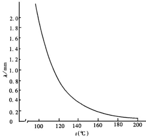
当加速电压比较小时，电子在加速场中所获得的能量小于汞原子的第一激发能，二者只能发生弹性碰撞，电子在加速场中所获得的能量必须大于经历一次弹性碰撞所损失的能量，这样电子就有可能集聚齐足够的能量去激发汞原子。当炉温升高的时候，由上图可知电子的平均自由程减小，电子的一个自由程中所获得的能量就会减小，这时电子激发汞原子的能力减弱，因此只有在较高的加速电压下，电子才可能获得足够的能量来激发汞原子，所以实验曲线中的第一个峰位随着炉温的升高而向右移动。但是当炉温过高时，由于电子的弹性碰撞很多，弹性碰撞损失了很多能量，虽然  $V_{G2K}$  到达一定的数值，电子仍然不能进行有效的能量交换，从而导致第一个峰位消失。
