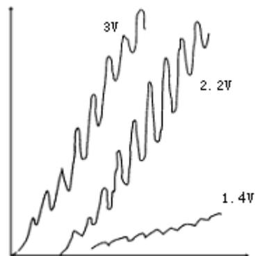
(注:上面两图中左图为自己实验所测得图,图中曲线在上面的对应较高的灯丝电压;右图是为了更清楚的对比灯丝电压对曲线的影响,从网上下载的别人的实验图<sup>[1]</sup>)
