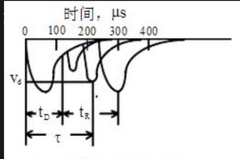
图 4 观察G-M管死时间和恢复时间的示波图
