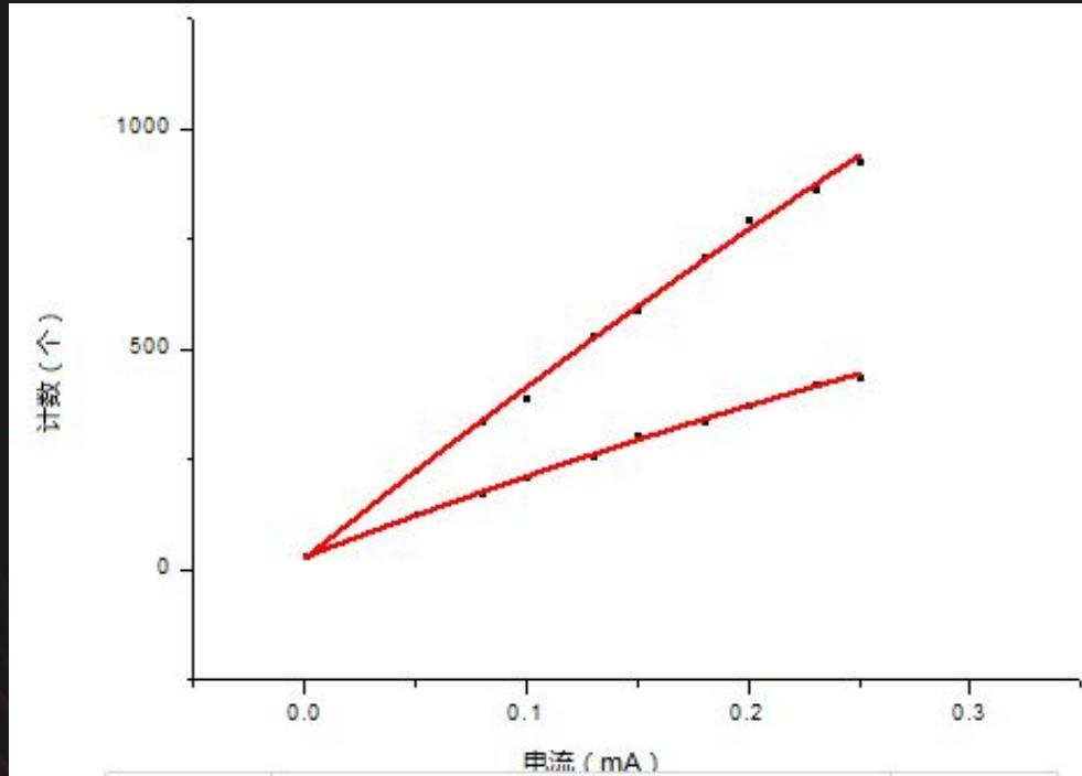
图：100k $\Omega$ 时微分对系统的影响
