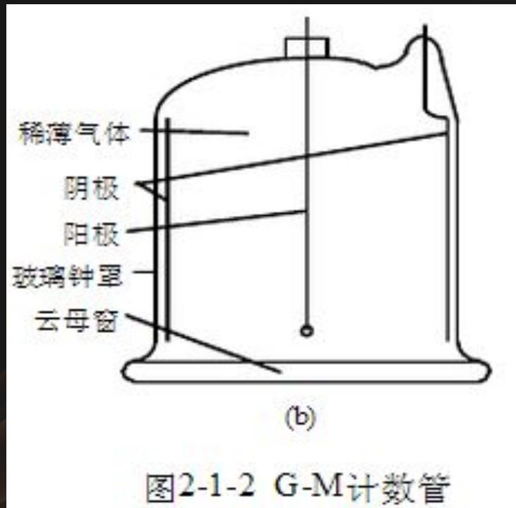
② 气体分子电离后，外加电场，电子(或负离子)与正离子会被电场拉开，沿电场方向漂移。在外加电场作用下收集电荷。
