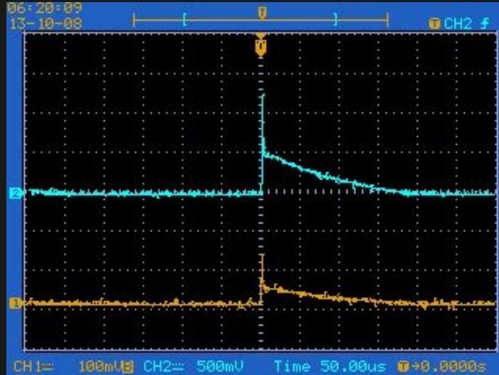
(b)  $R=1\text{k}\Omega$ 的波形示意图
