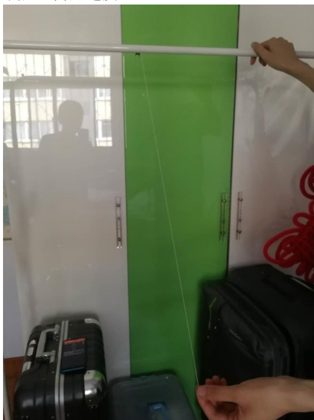
图二 使用自由落体测量重力加速度
