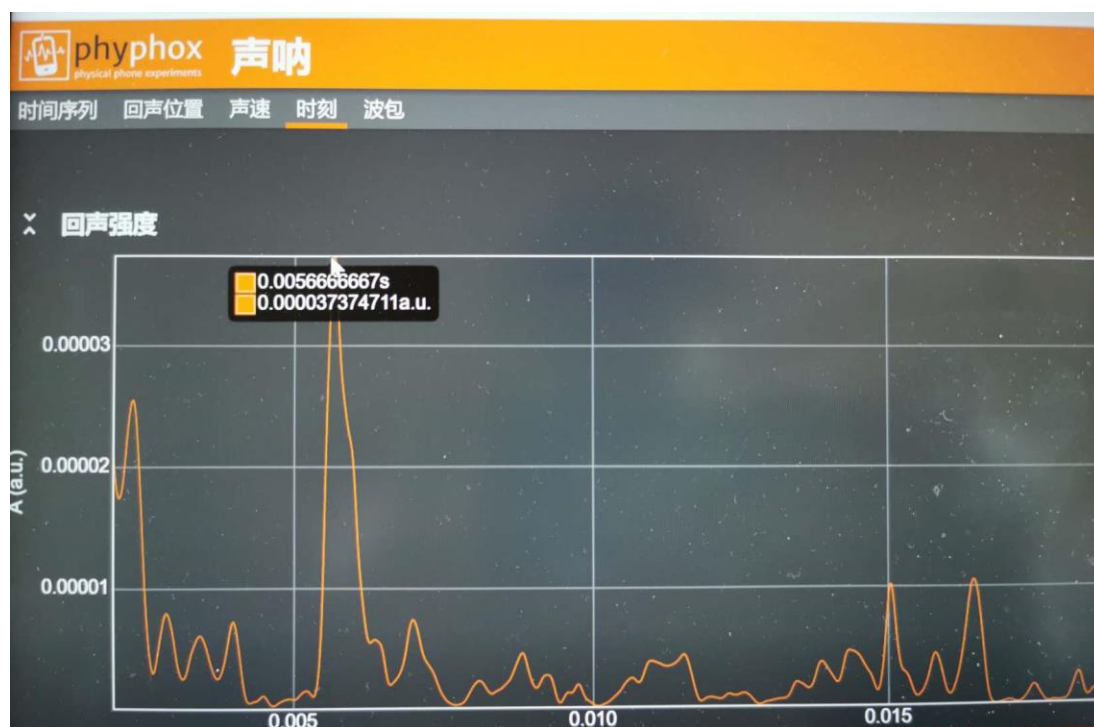
图 1. 回声强度-时延图像（空气）
