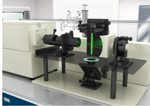
图 4 四氯化碳拉曼光谱的测定
