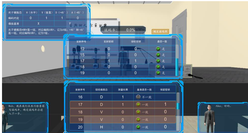
图五：保留一致基准下的密钥并检查误码率
