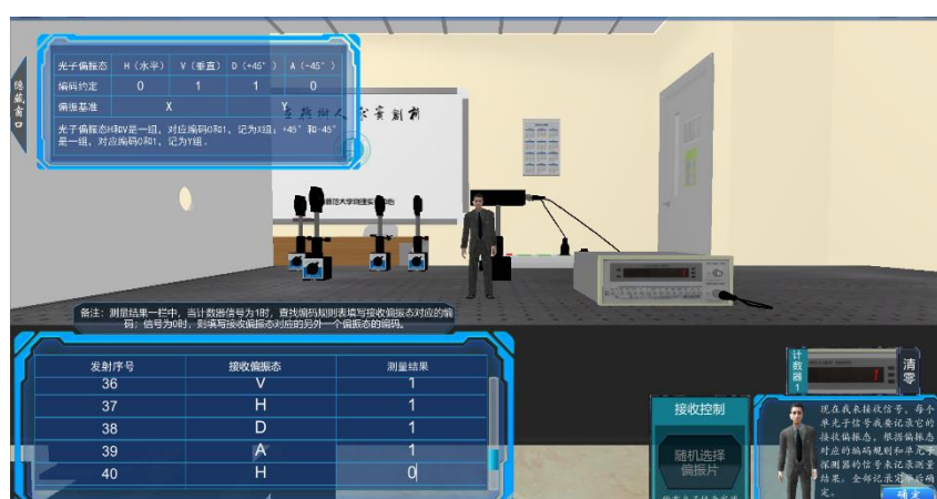
图四：接收并测量单光子偏振态
