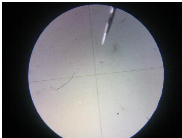
图二、交流电腐蚀产生的针尖
