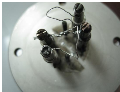
图二 测量钨带温度时的法兰盘装法
