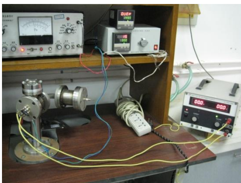
图一 钨带温度的测量电路
