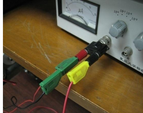
图四 前级观察时电流计的输入端
