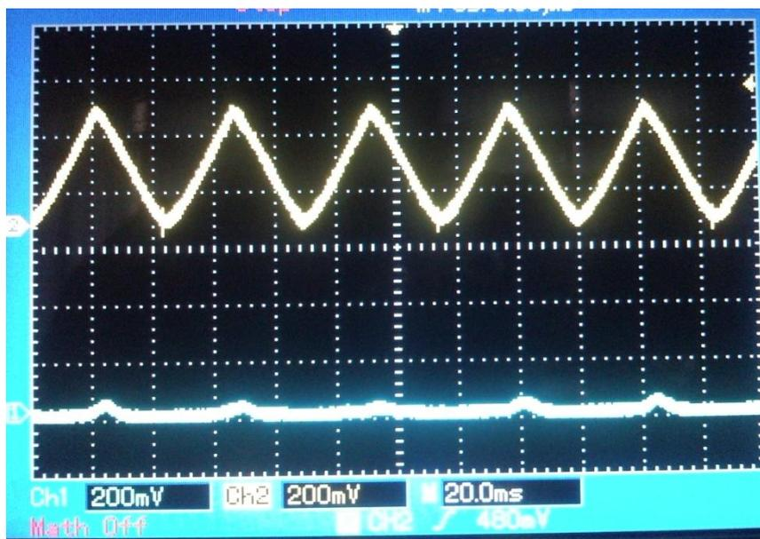
图 9、加入三角波后的信号波形。此时，水平磁场强度略大于地磁场水平分量强度
