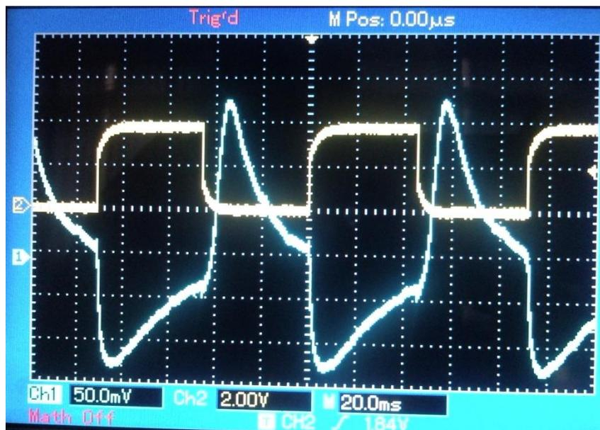
图 3、不加水平和垂直的恒定磁场，加入与地磁场同向的扫场信号，获得的波形
