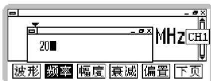
键入您想输入的数字后，你可以按【OK】键来按照当前的单位来输入频率值，也可以按快捷键的单位功能来输入以 Hz、KHz、MHz 为单位的频率值。
