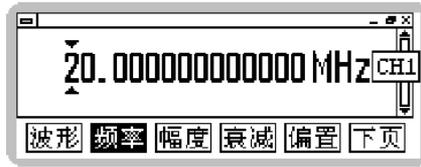
4. 用同样的方法选择“幅度”、“偏置”菜单，并输入幅度为 5V，偏置为-1V，这样，要求的波形就输出了。
