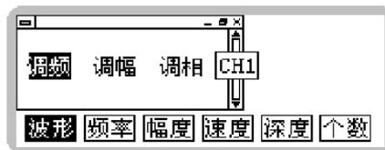
2. 让“波形”菜单指向调频后，按指向【速度】的屏幕键【F4】来设置调制的速度即调制波的速度为 0.01S（即为 100Hz）；
