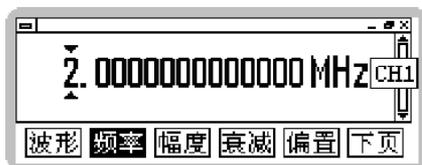
系统默认频率为 10MHz，这时您可以通过按下【调幅】、【调频】、【幅度】快捷键来选择显示的单位为 Hz、KHz、MHz。这时您可以用三种方法来输入频率：（数字量输入此方法通用）
