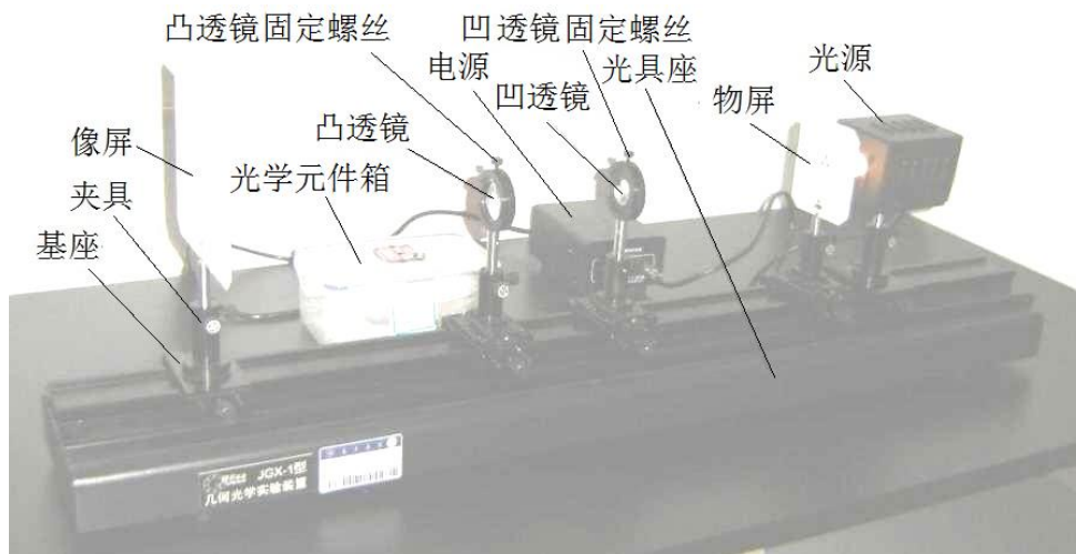
图 7 透镜焦距测量的实验装置
