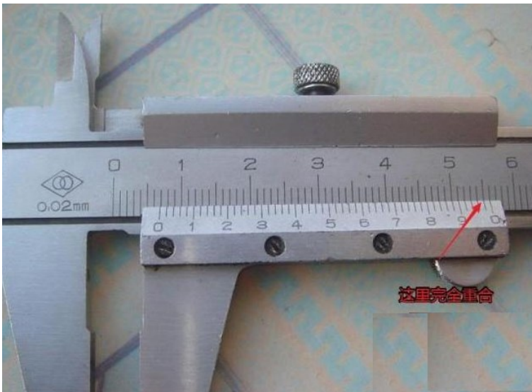
图 1 用游标卡尺测量某物体的长度
