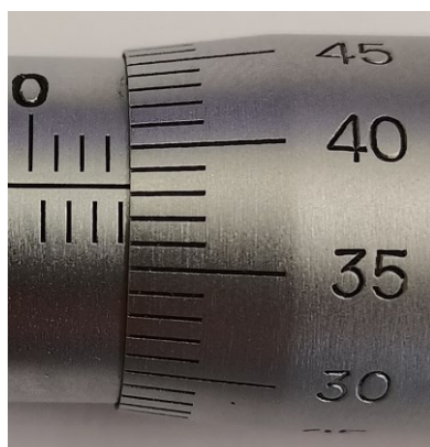
图 2 用千分尺测量某物体的厚度
