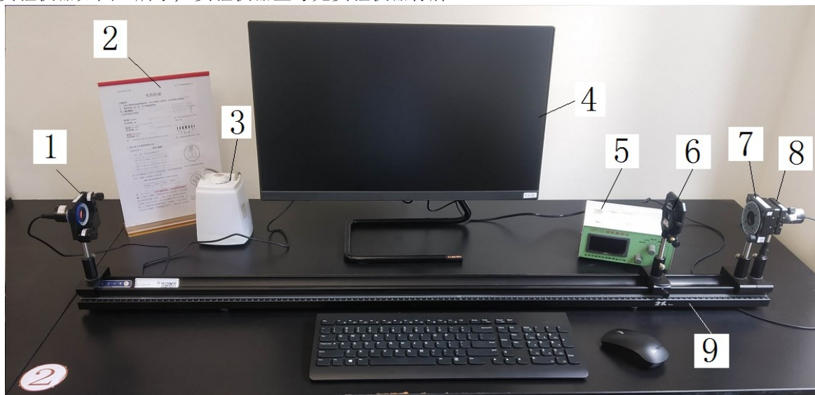
图 9 夫琅禾费衍射实验装置示意图
