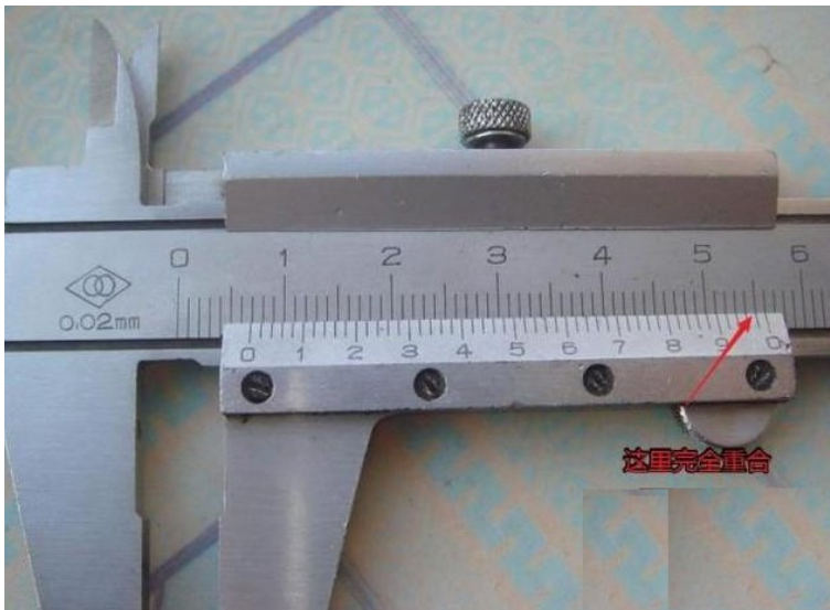
图 1 用游标卡尺测量某物体的长度
