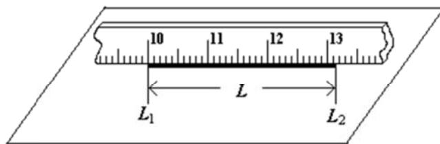
图 1 用钢尺测量长度
