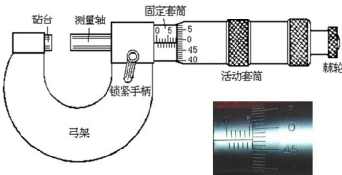
图 3 千分尺结构图
