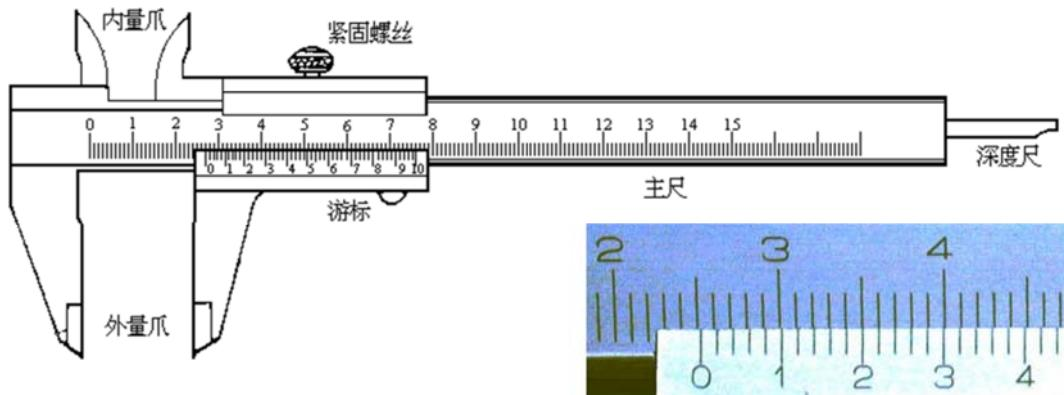
图 2 游标卡尺的结构图
