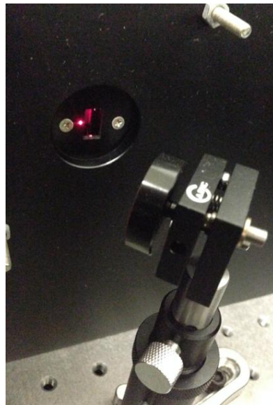
图表 33 扩束激光经过球面镜反射后在入射缝周围聚焦
