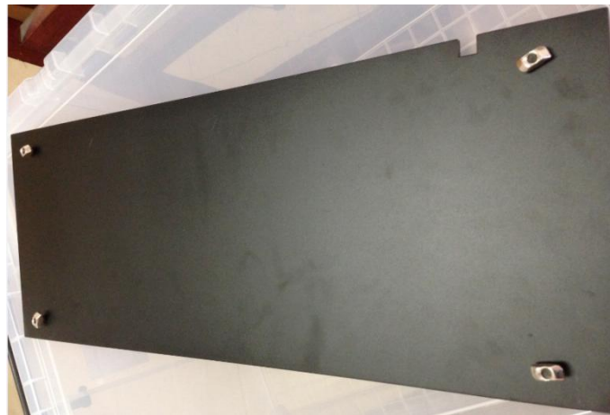
图表 16 将 T 型螺母安装在铝板零件 4 角
