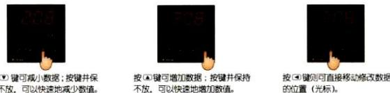
采用 AI 人工智能 PID 方式进行控制时，可进行自整定 (AT) 操作来确定 PID 调节参数。在基本显示状态下按 (◀) 键并保持 2 秒，将出现 At 参数，按 (△) 键将下显示窗的 oFF 修改为 on，再按 (◀) 键确认即可开始执行自整定功能。在基本显示状态下仪表下显示窗将闪动显示“At”字样，此时仪表执行位式调节，经 2 个振荡周期后，仪表内部微处理器可自动计算出 PID 参数并结束自整定。如果要提前放弃自整定，可再按 (◀) 键并保持约 2 秒钟调出 At 参数，
