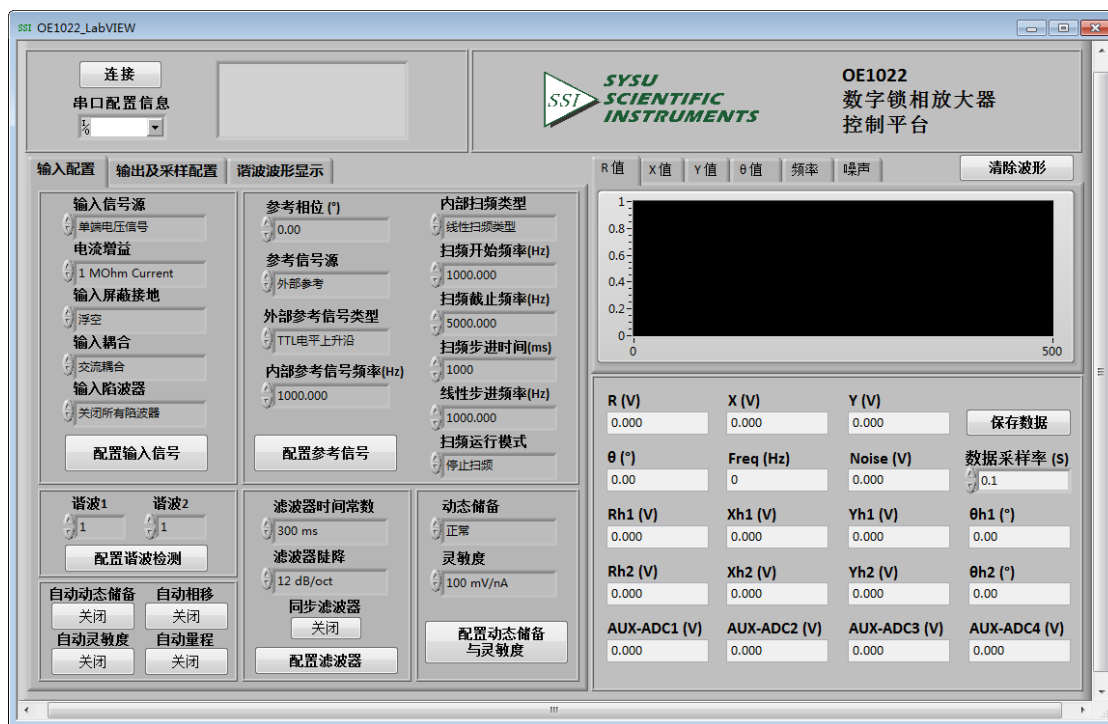
图 3-16 OE1022 数字锁相放大器控制平台界面
