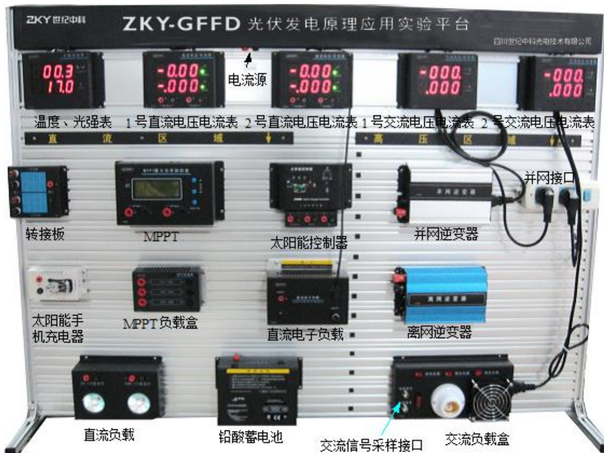
图 9 光伏发电原理应用实验平台整机正面照片
