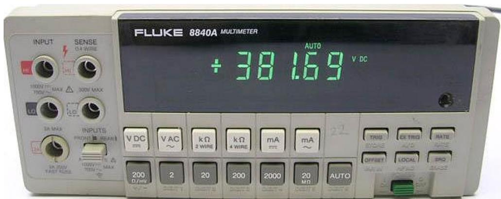
8840A 数字万用表同样可以通过 GPIB 联机使用。在远程控制模式下, 控制软件可以为其选择工作模式, 并接收记录万用表测得的数据。根据前面得到的公式, 计算机程序可以自动将电压信号转换成温度读数。
