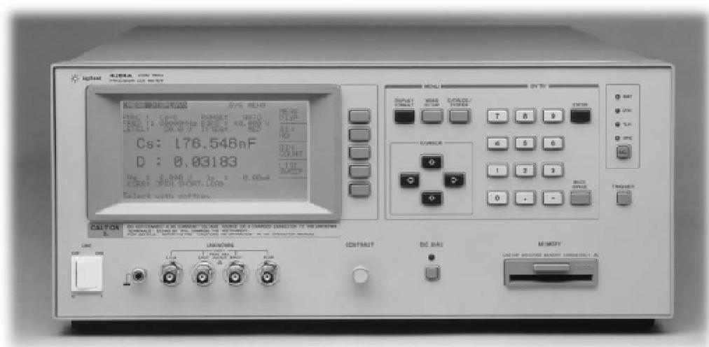
4284A仪器面板照片如上。左下角白色塑料开关为仪器电源开关，其右五个接线柱依次为地端、低电流端（Lcur）、低电压端（Lpot）、高电压端（Hpot）、高电流端（Hcur）。上方液晶屏可以显示仪器的工作状态，辅助面板手动操作设置，并且实时显示测量参数和测量读数。液晶屏右下方的金属旋钮用来调节显示对比度。右边的红色发光二极管显示直流偏置信号（电压或电流）是否加载；在面板手动操作时，二极管下方的方形软开关可以控制直流偏置信号的开关。面板右上方的四只橙色发光二极管显示GPIB接口的工作状态，从上到下依次为：RMT（remote），遥控操控模式；LTN（listen），本地接受数据信号，TLK（talk），本地发送数据信号；SRQ（service request），远程服务器任务请求；二极管下方LCL（Local）方形软按钮可以将LCR表切换到面板手动控制模式。而在面板手动控制模式下，通过面板上的功能、光标、数字按钮可以进行菜单设置操作。
