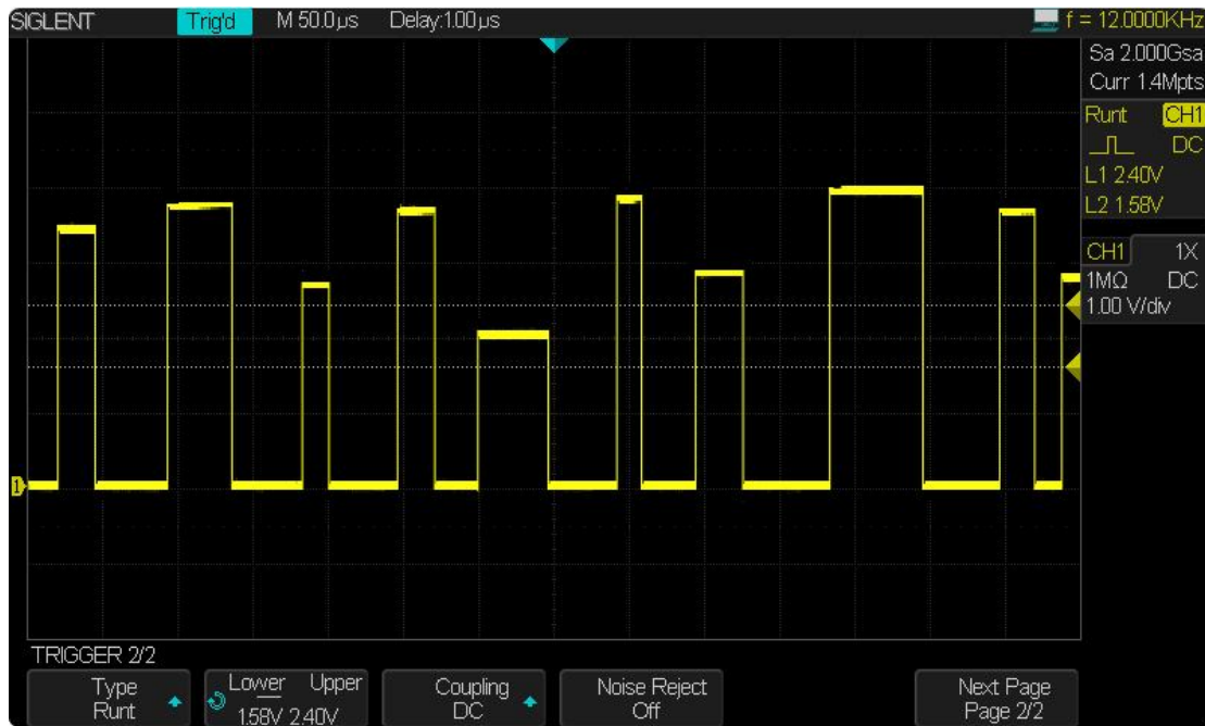
图 46 欠幅脉冲触发
