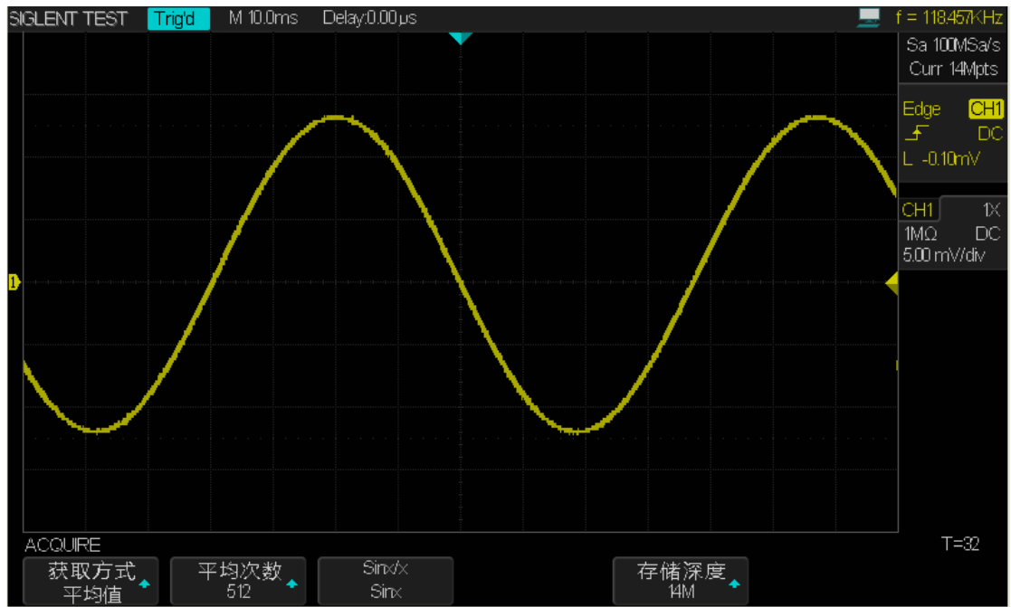
图 32 平均次数为 512 时的波形（降低随机噪声）
