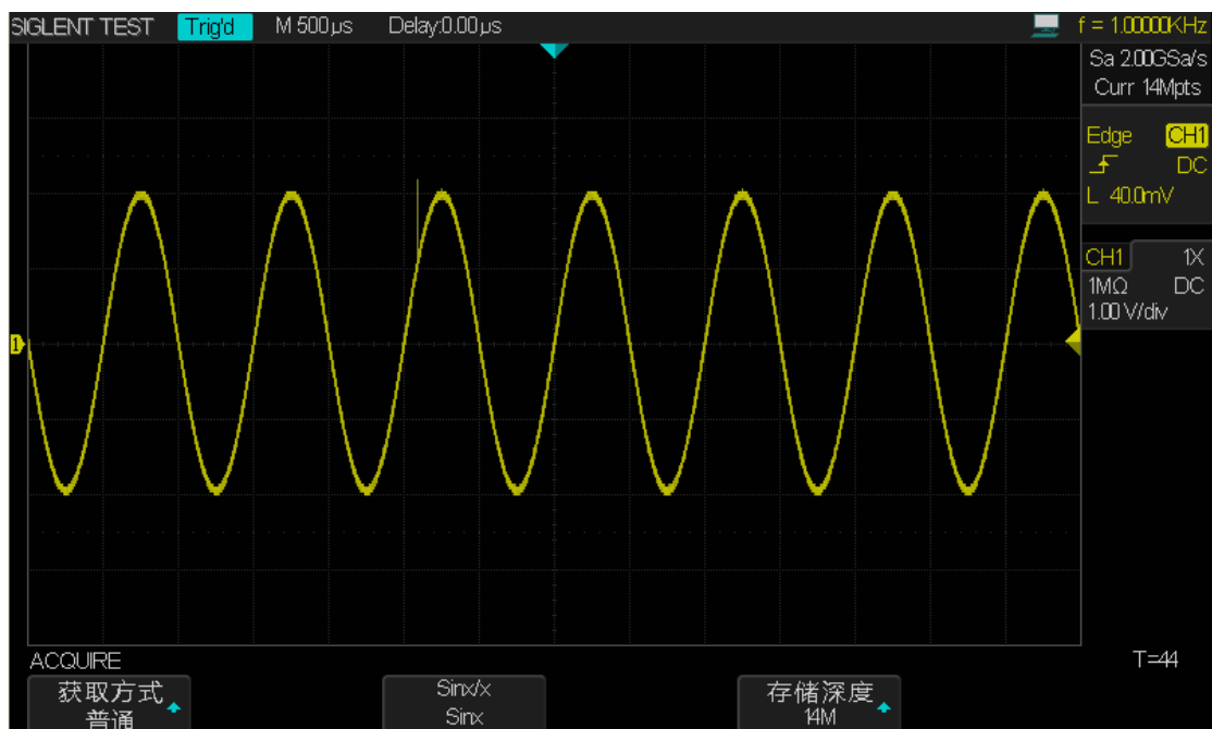
图 28 带毛刺的正弦波（普通模式）
