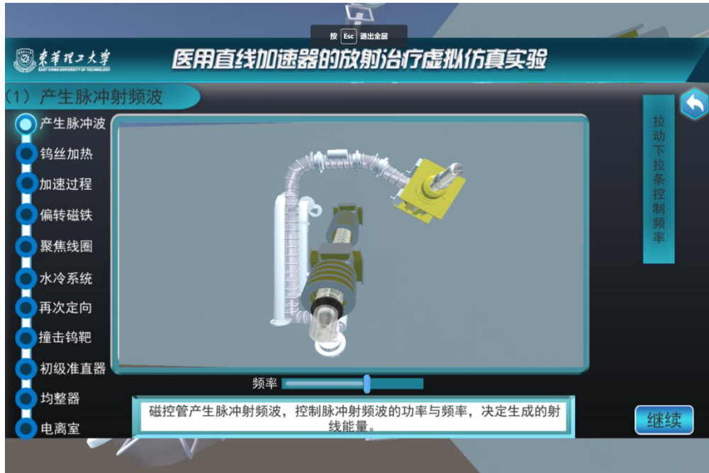
图十一 通过频率控制射频波
